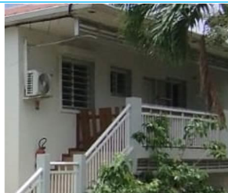
Matériaux : Z08 - Façades extérieures - Mur - enduit + peinture Prélèvement : P016 Description : enduit + peinture Localisation : Bat 2 - Façades Extérieures - Mur Résultat : Absence d'amiante
